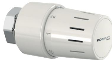
Thermostatkopf in kompakter und robuster Bauform, mit Gewindeanschluss M 30 x 1,5, mit eingebautem Flüssigkeitsfühler, Blockierung und/oder Begrenzung des Einstellbereiches ist einfach und kann vor Ort vorgenommen werden.
