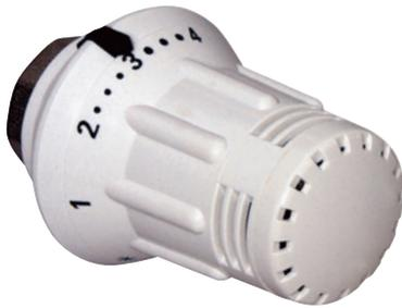
TELL zertifiziert, passt ohne Adapter auf integrierte Ventilgarnituren mit Gewindeanschluss M 30 x 1,5. Steigende Spindel, somit ändert sich die Länge des Kopfes beim Betätigen (max. Länge: 90 mm).
